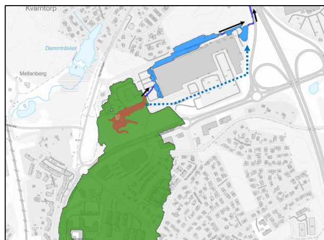
Figur 12. Osäkerhet gällande vattnets väg sid Port 73. Det är osäkert om ytligt avrinnande vatten rinner norr om byggnaden som Scalgo Live visar (svarta pilar) eller söder om byggnaden (blå streckad bil). (Bild från WSP 2025a, framtagen med Scalgo Live).
