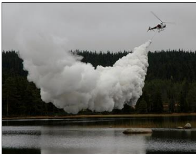
Bild 22: Sjöalkning utförs för att höja pH-värdet i en försurad sjö. Foto: Ingrid Tidemalm – VLK
